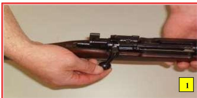
Primeiro colocar a arma em segurança, verificar a ausência de munição no seu interior. Com uma mão pegar no puxador da culatra (Fig. 1)
