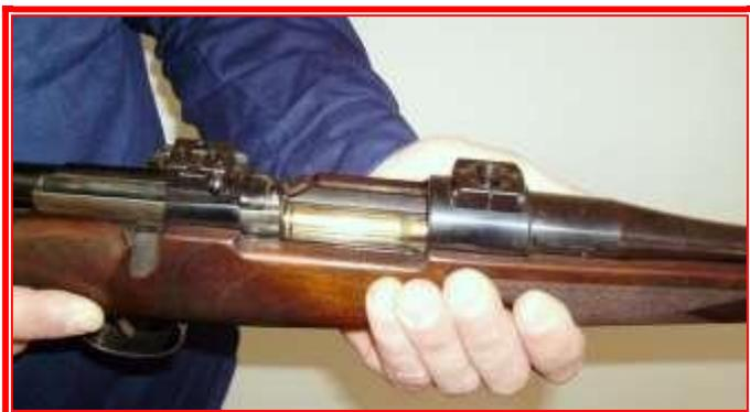
Com a arma em segurança introduz-se a munição na Câmara
