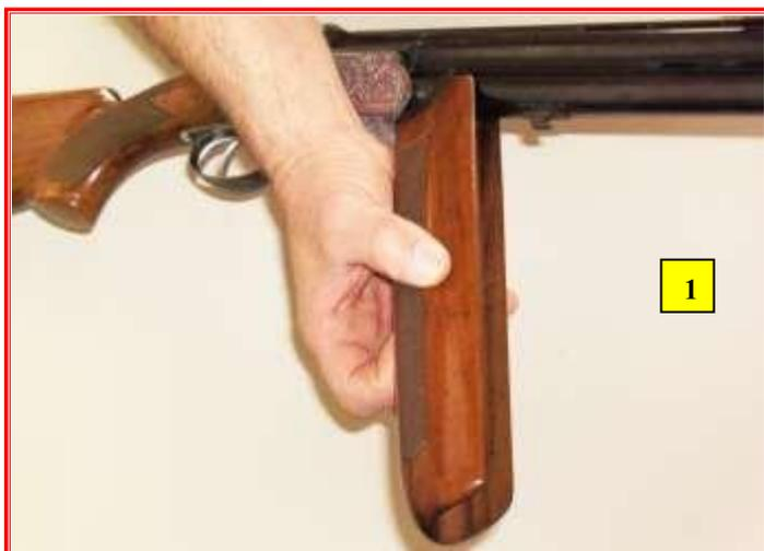
Primeiro verifica-se se a arma está em segurança e se existem cartuchos no interior do cano. De seguida abre-se o fecho do fuste e retira-se o mesmo (Fig. 1).
