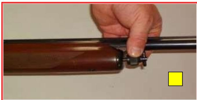
Primeiro, colocar a arma em segurança, verificar a ausência de cartuchos no interior do carregador e do cano e desapertar a tampa do guarda mão. (Fig. 1)
