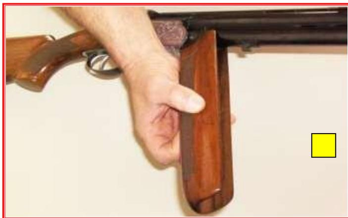
Com uma mão pega-se no fuste encaixando-o com a parte posterior no local apropriado na básica. (Fig. 7)
